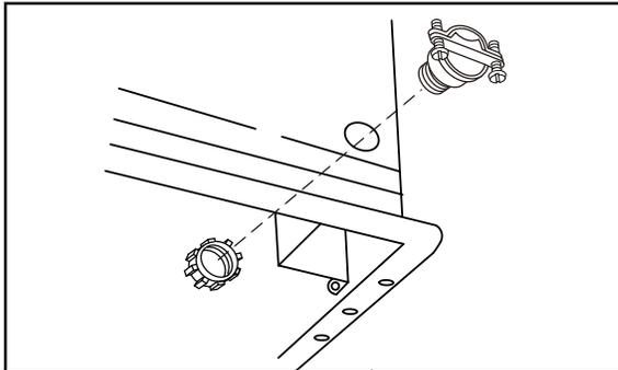
1. Poser le coupleur de fils certifié UL ou autre organisme ou la bague de rétention (en sus) en travers du trou ou de l'ouverture sur le caisson.
