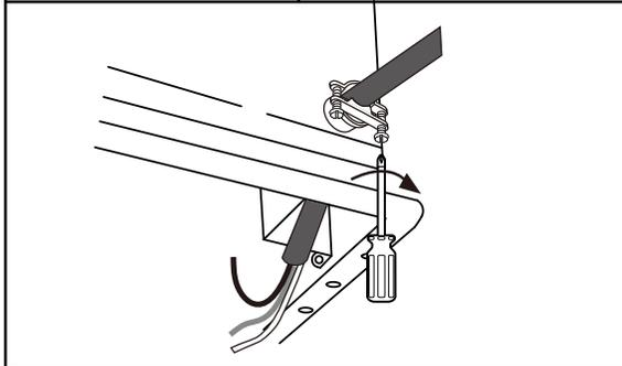
2. Posez le conduit ou le câble cuirassé en travers du coupleur. Serrez le câble à l'aide de deux vis.
