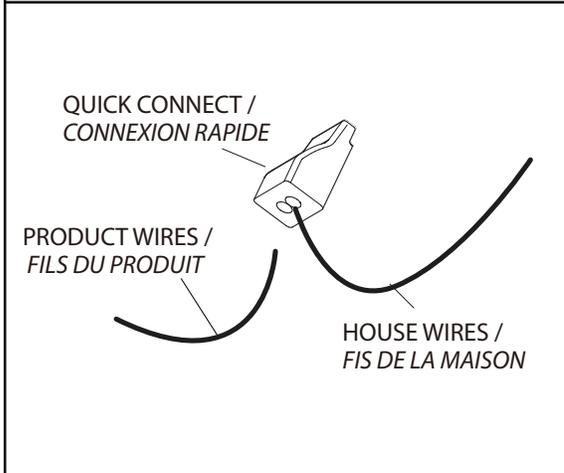
3. **MISE EN GARDE:** Le filage électrique doit être conforme aux normes applicables. Mettre hors tension avant de poser ou retirer un serre-fils. **MISE EN GARDE:** Utiliser des fils de cuivre et jamais de fil en aluminium
